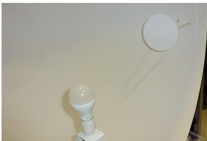
Lichtstromprüfling und Schatter im Innenraum der Ulbrichtkugel (Spektrometeröffnung hinter Schatter sichtbar)
