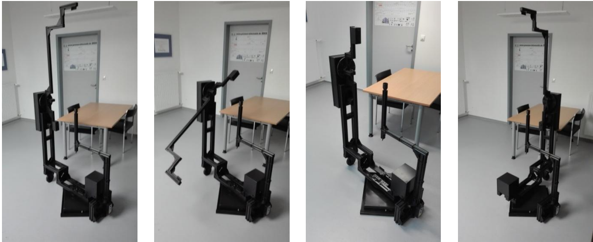
Zweiachsiges Goniometer (Eigenbau) im Messraum in verschiedenen Positionen
