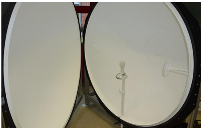
Geöffnete Ulbrichtkugel mit einem Reflektionsfaktor \rho = 98\%
