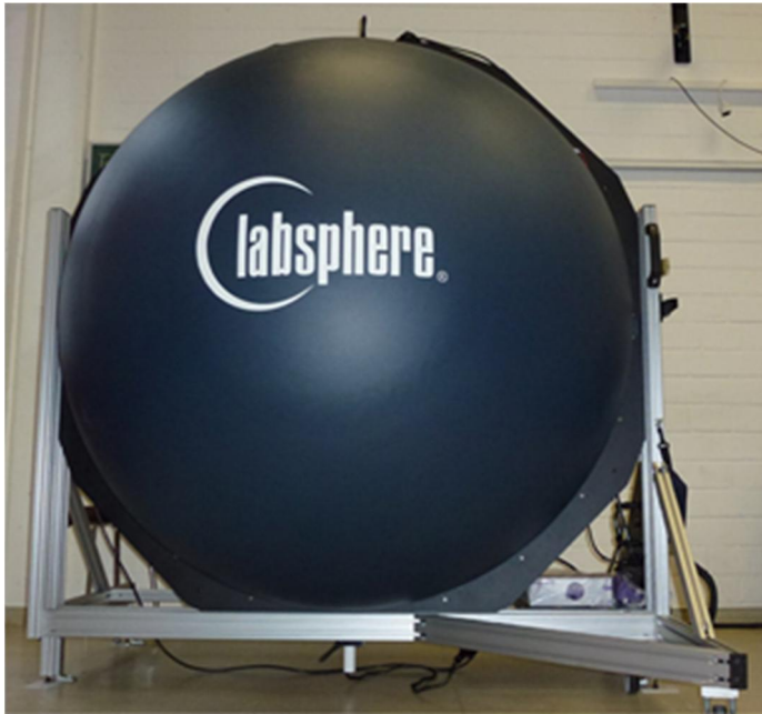
Ulbrichtkugel der Firma Labsphere mit D = 1,65\text{ m}
