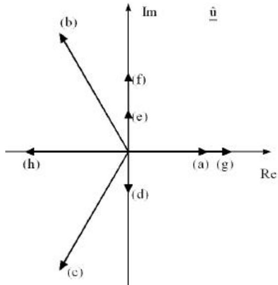
16.3) Die Spannungen aus 16.1 sollen als komplexe Schwingung angegeben werden auf der Grundlage, daß  $\cos(\omega t)$  dem Drehzeiger  $e^{j\omega t}$  zugeordnet ist.
